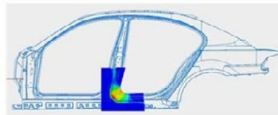
Abbildung 4: Türeintrittsöffnung im B-Säulenbereich des Seitenrahmens.
